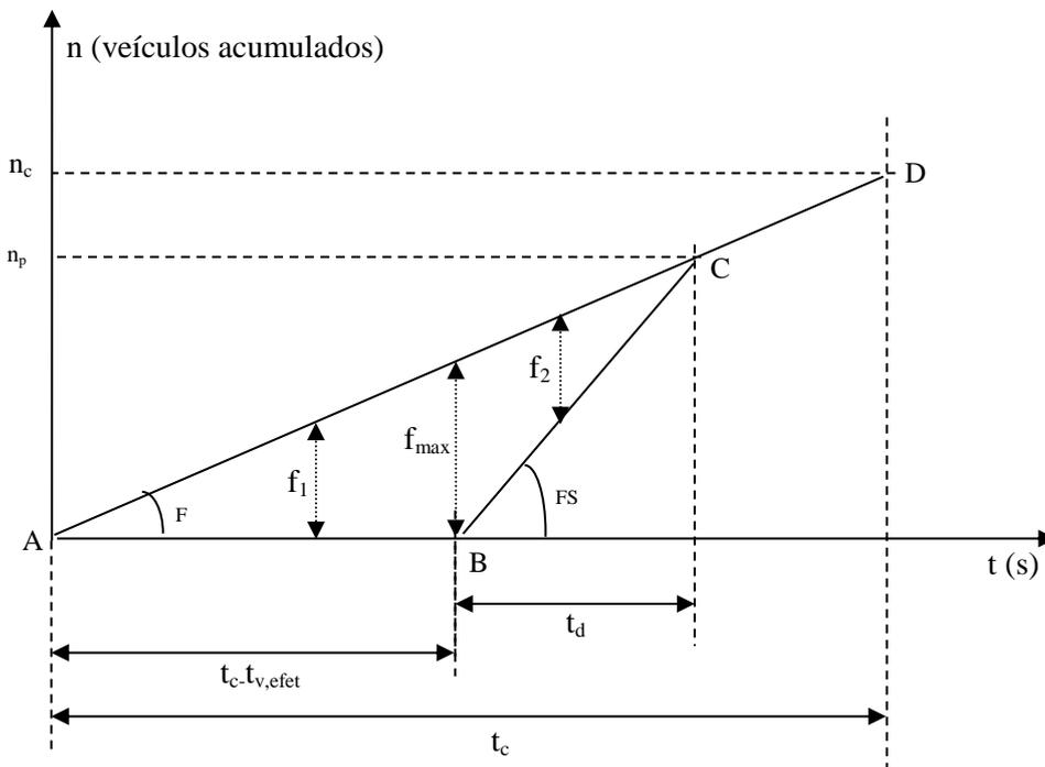
**Figura 6.10: Processo de formação e dissipação de fila**
