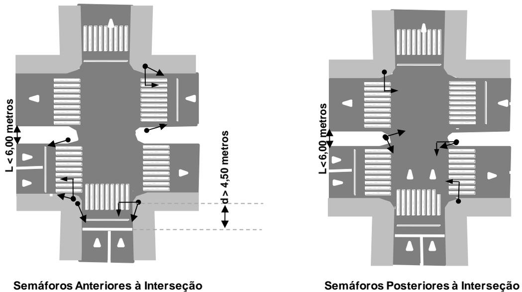
**Figura 10.7: Sinalização semafórica com caixa de acomodação insuficiente**
