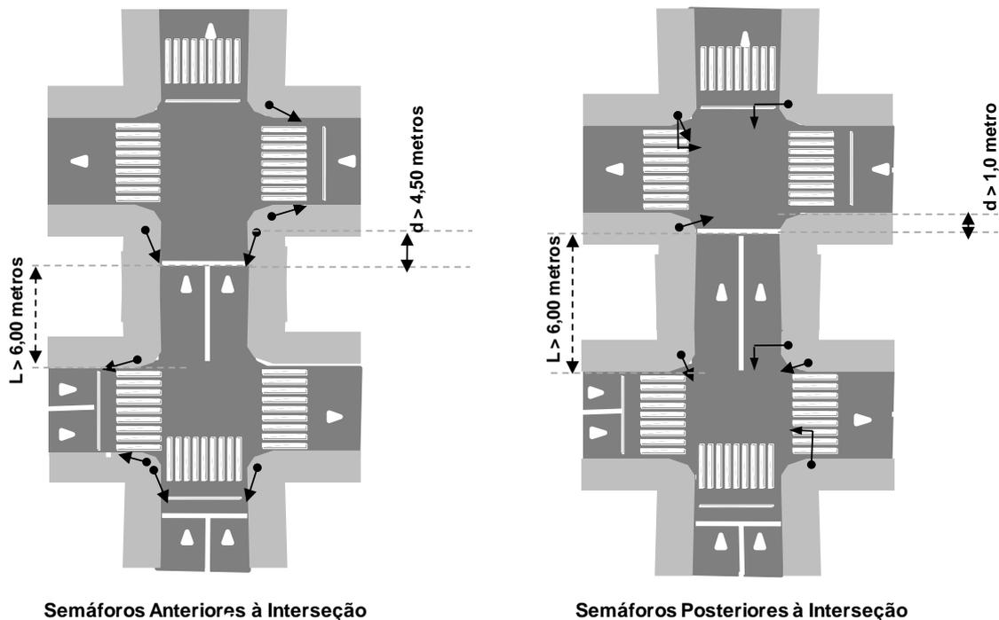
**Figura 10.8: Sinalização semafórica com caixa de acomodação suficiente**
