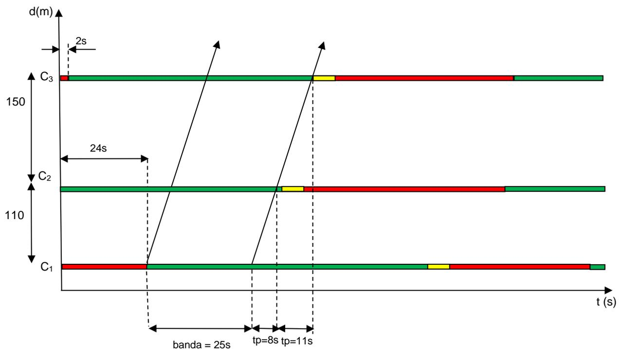
**Figura 9.12: Diagrama espaço-tempo do exemplo de via de mão única**
