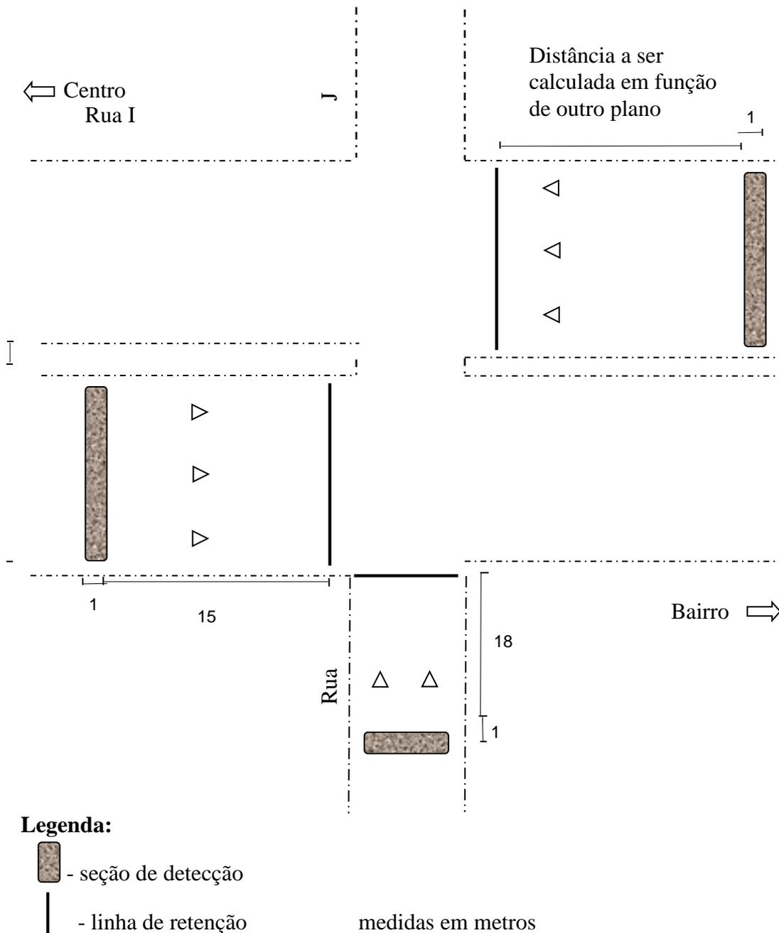
**Figura 8.8: Posicionamento das seções de detecção**
