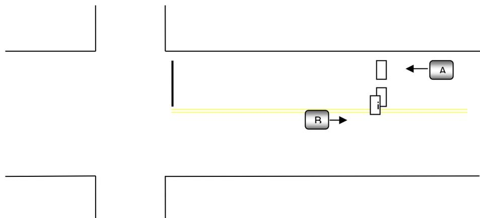
Figura 8.2: Posicionamento de laço detector inibidor
