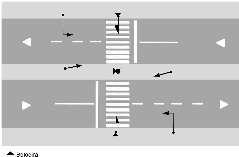
**Figura 10.10: Exemplo da travessia em um único estágio**
