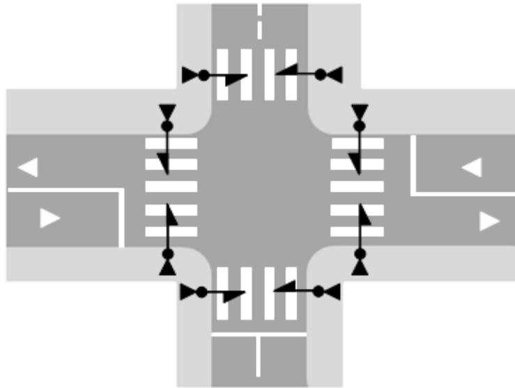
**Figura 10.13: Posicionamento da boteeira junto à interseção**
