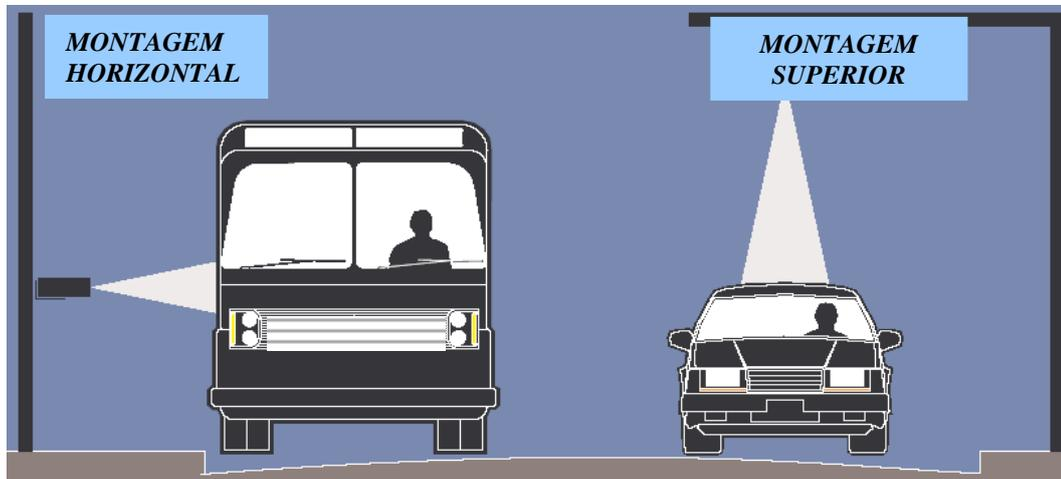
**Figura 3.13: Formas de posicionamento dos detectores ultrassônicos**
