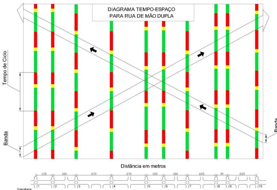
**Figura 9.5: Exemplo de diagrama espaço-tempo para uma via de mão dupla**
